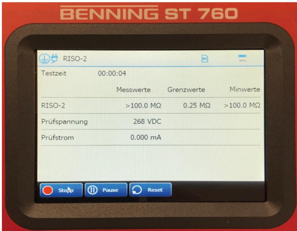
4. Isolationswiderstand zwischen Primärseite u n d Sekundärseite
