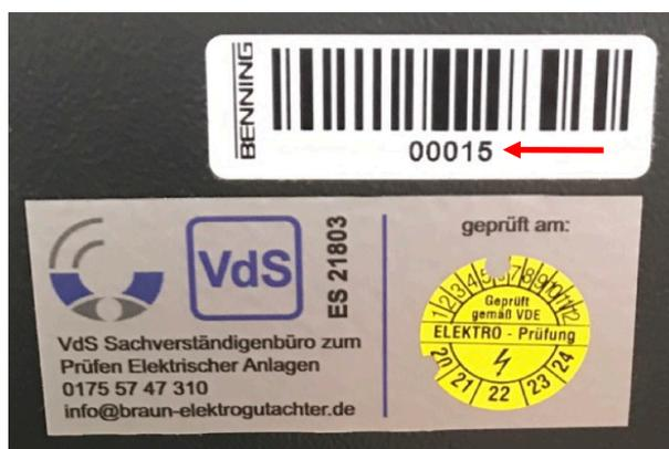
Die Ident - Nr und die Prüfplakette werden an das Gerät angebracht.
